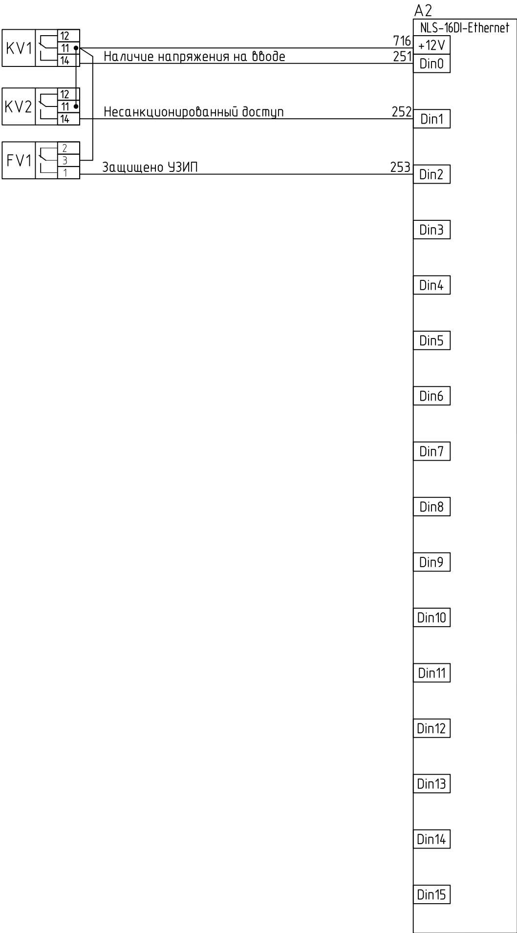
Схема подключения дискретных входных сигналов
