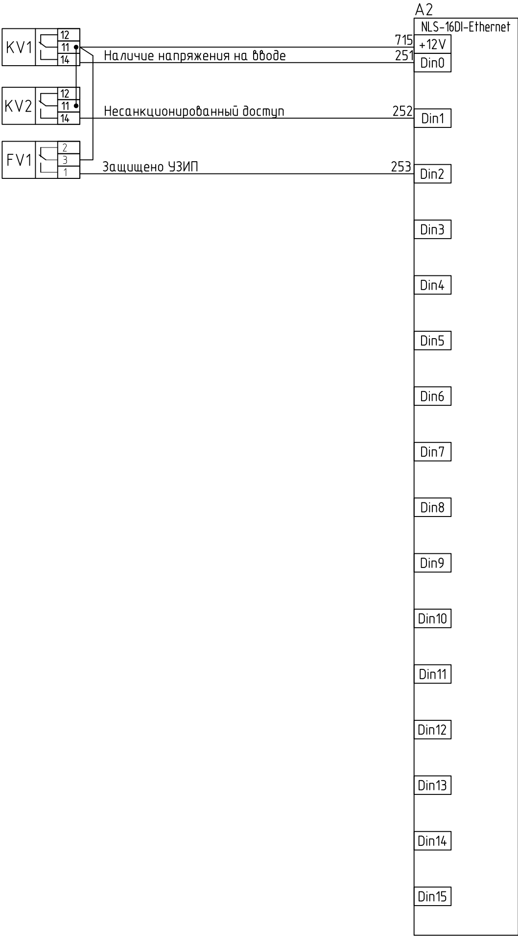
Схема подключения дискретных входных сигналов
