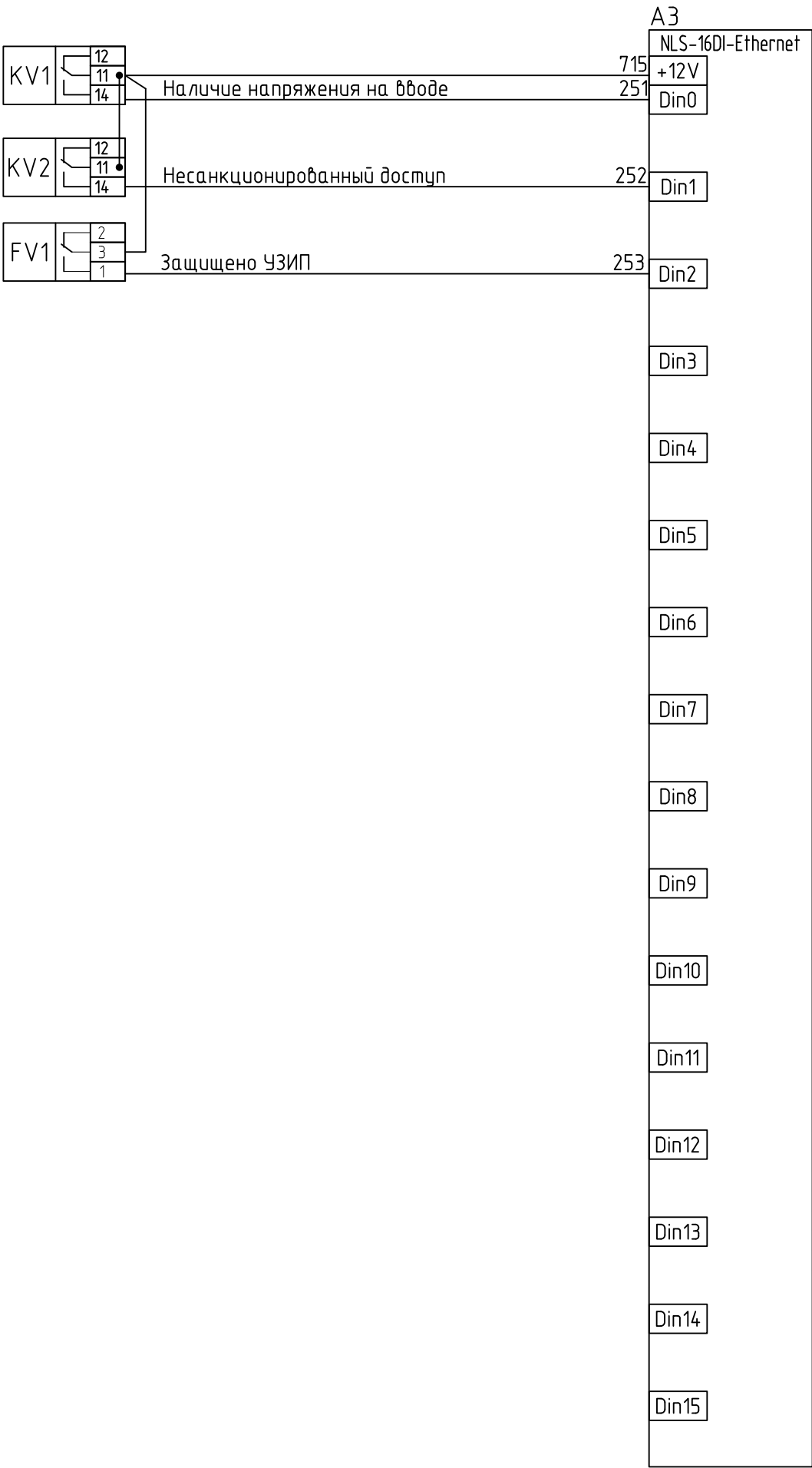
Схема подключения дискретных входных сигналов
