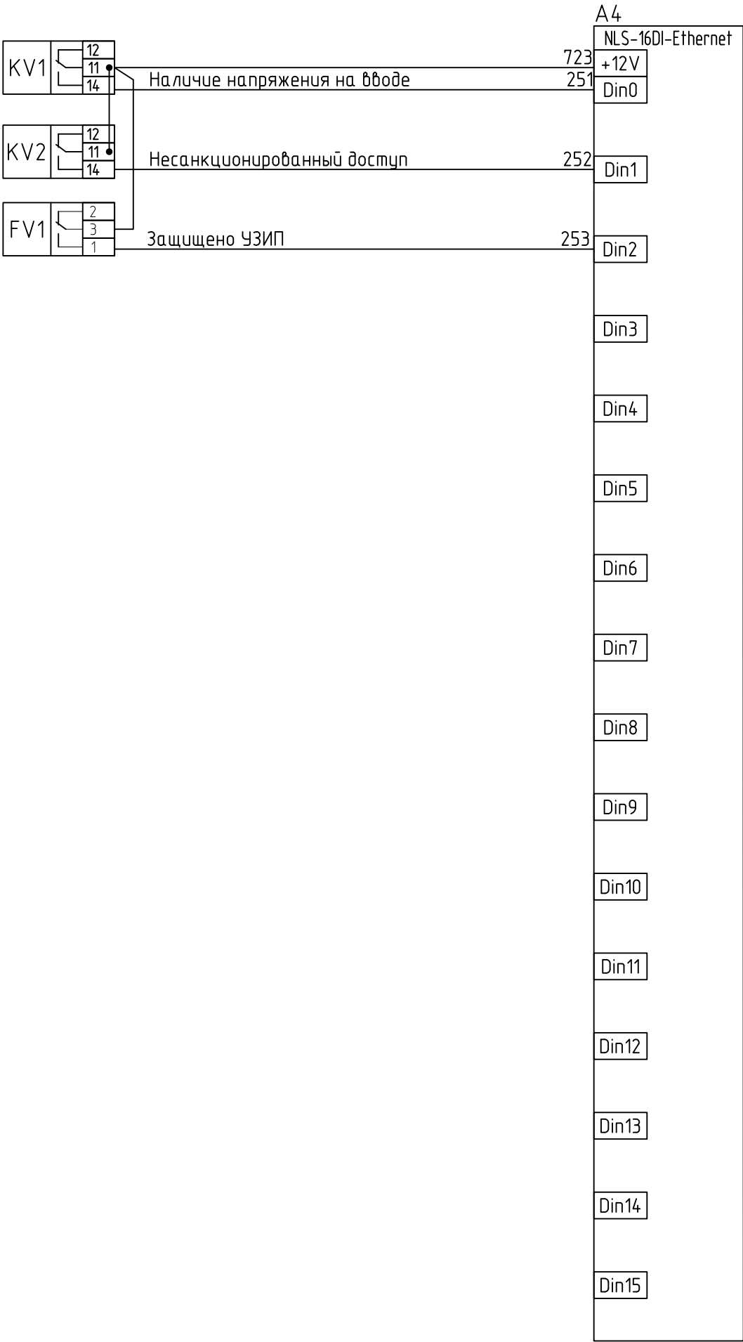
Схема подключения дискретных входных сигналов
