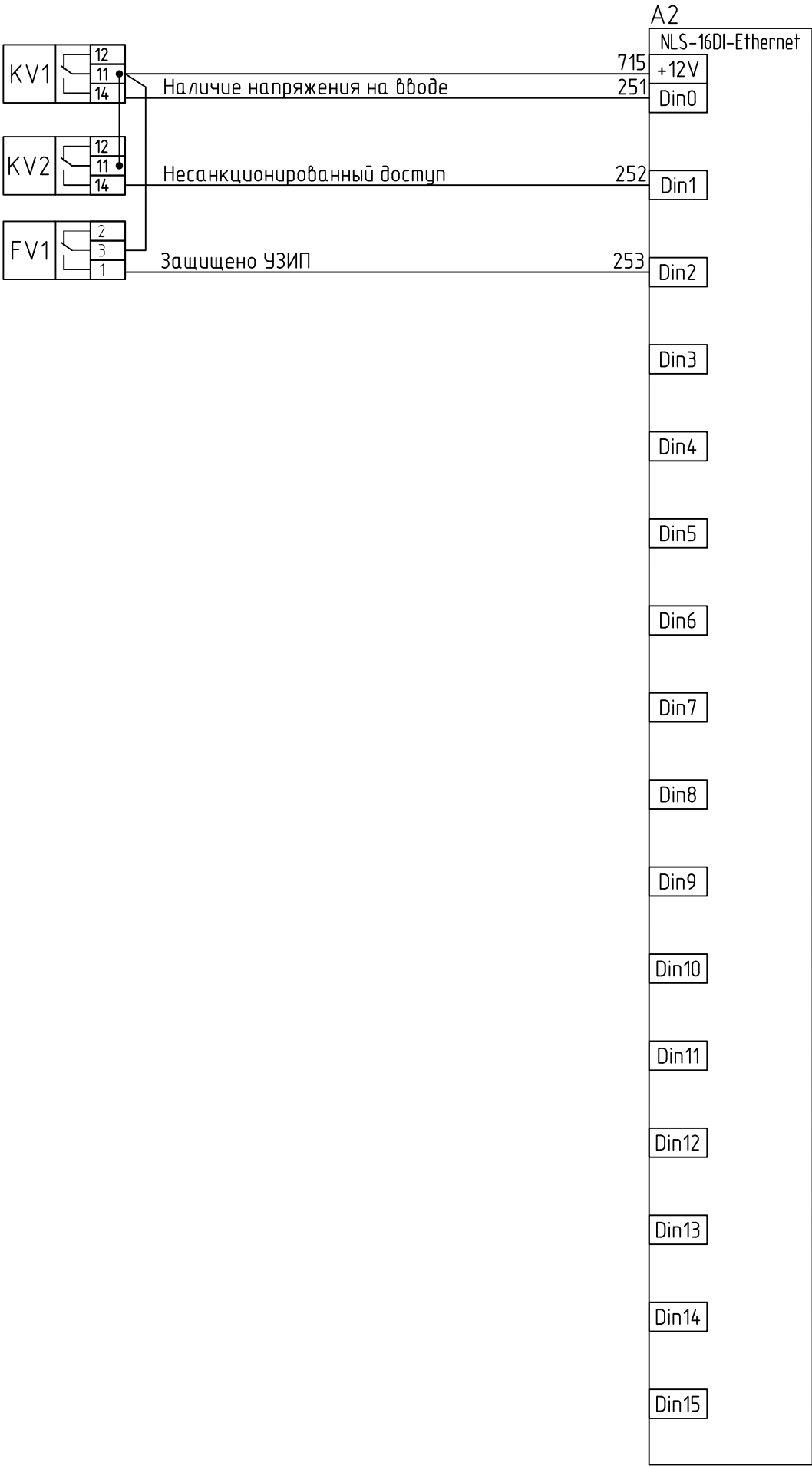
Схема подключения дискретных входных сигналов
