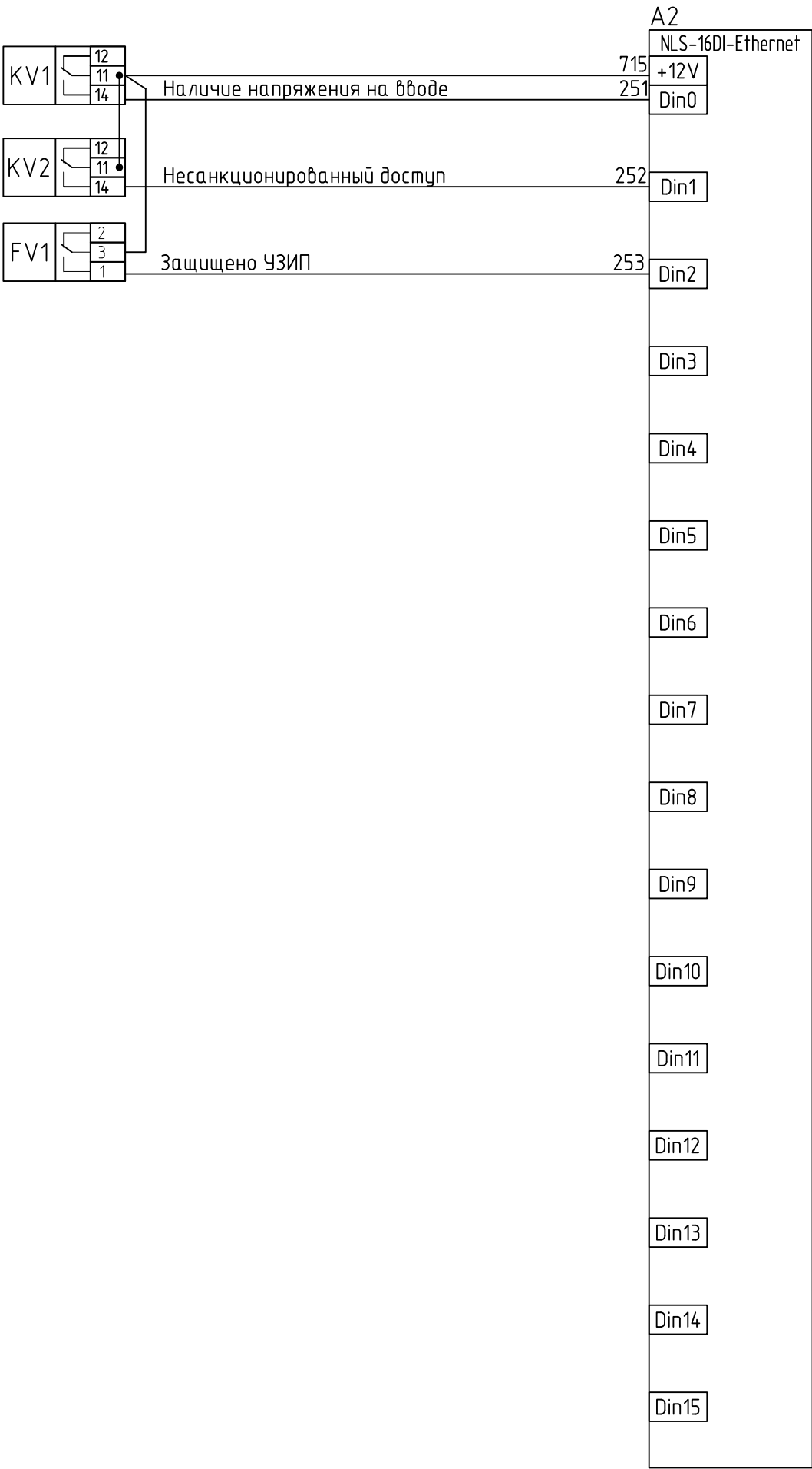
Схема подключения дискретных входных сигналов
