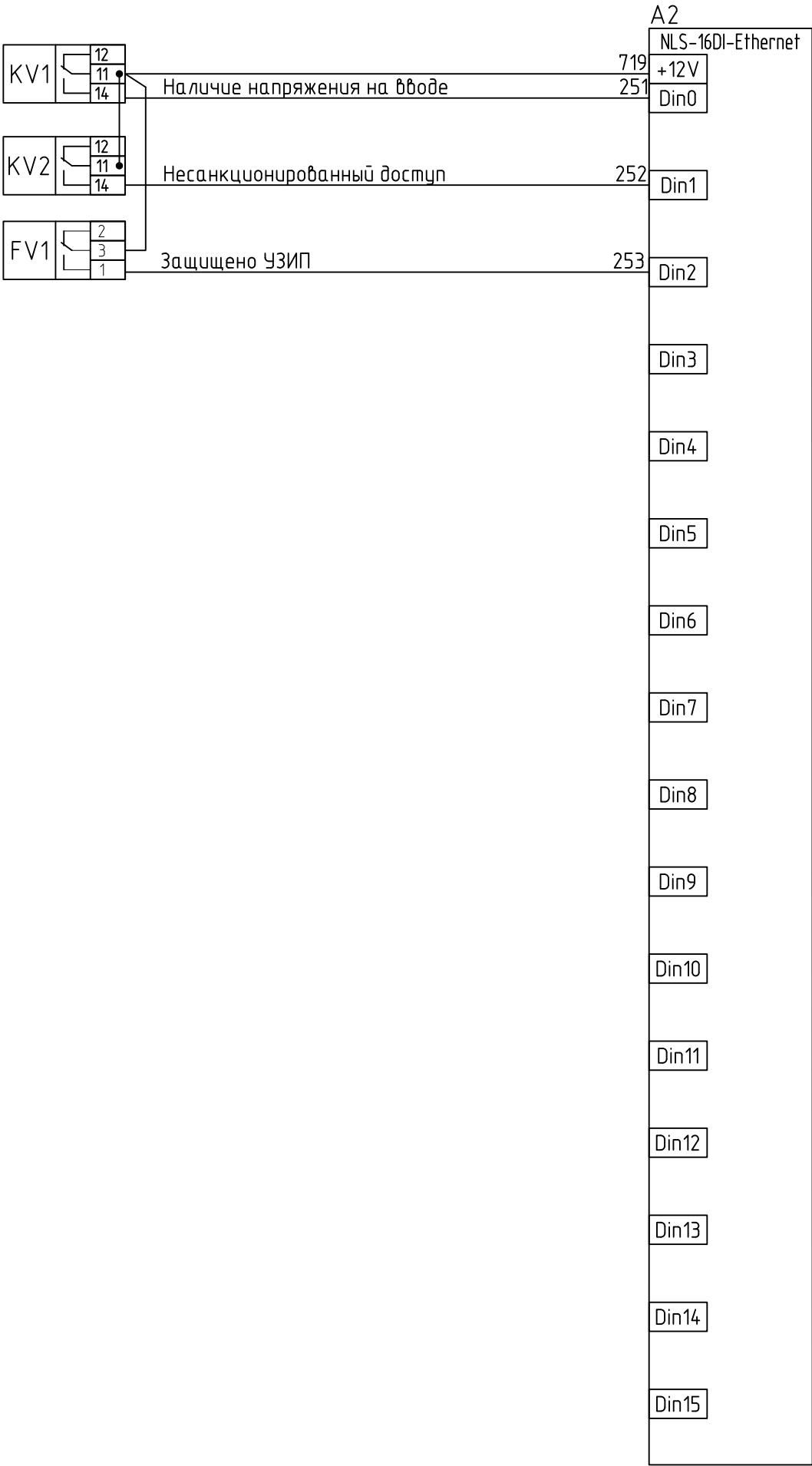
Схема подключения дискретных входных сигналов
