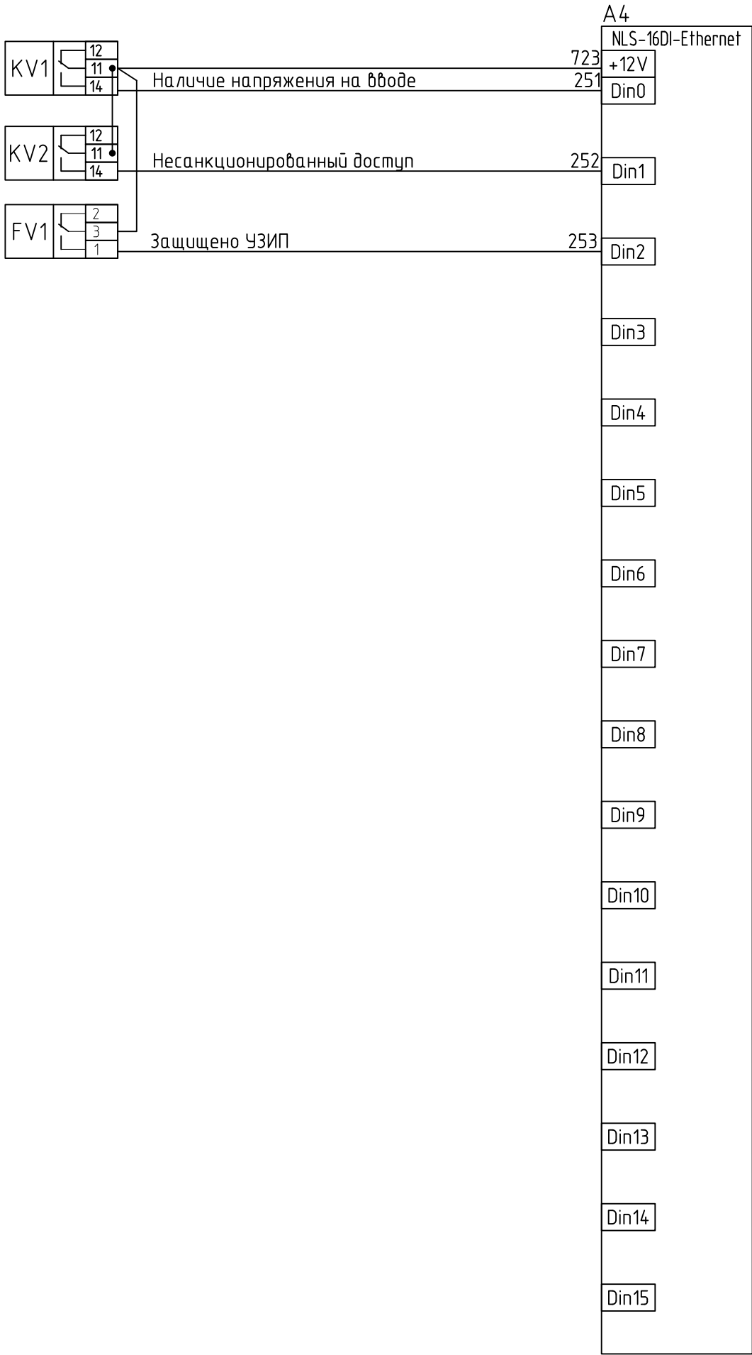
Схема подключения дискретных входных сигналов
