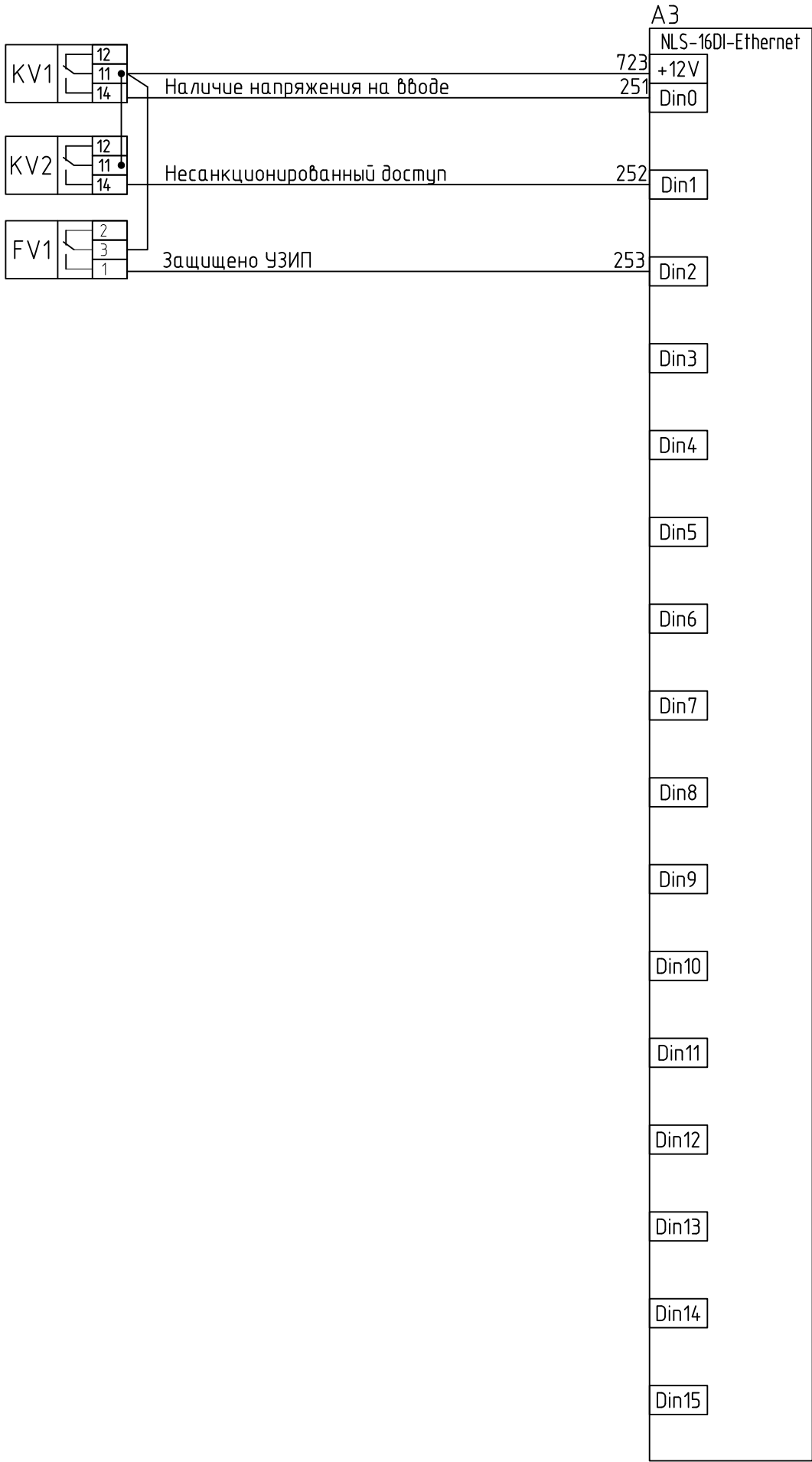
Схема подключения дискретных входных сигналов
