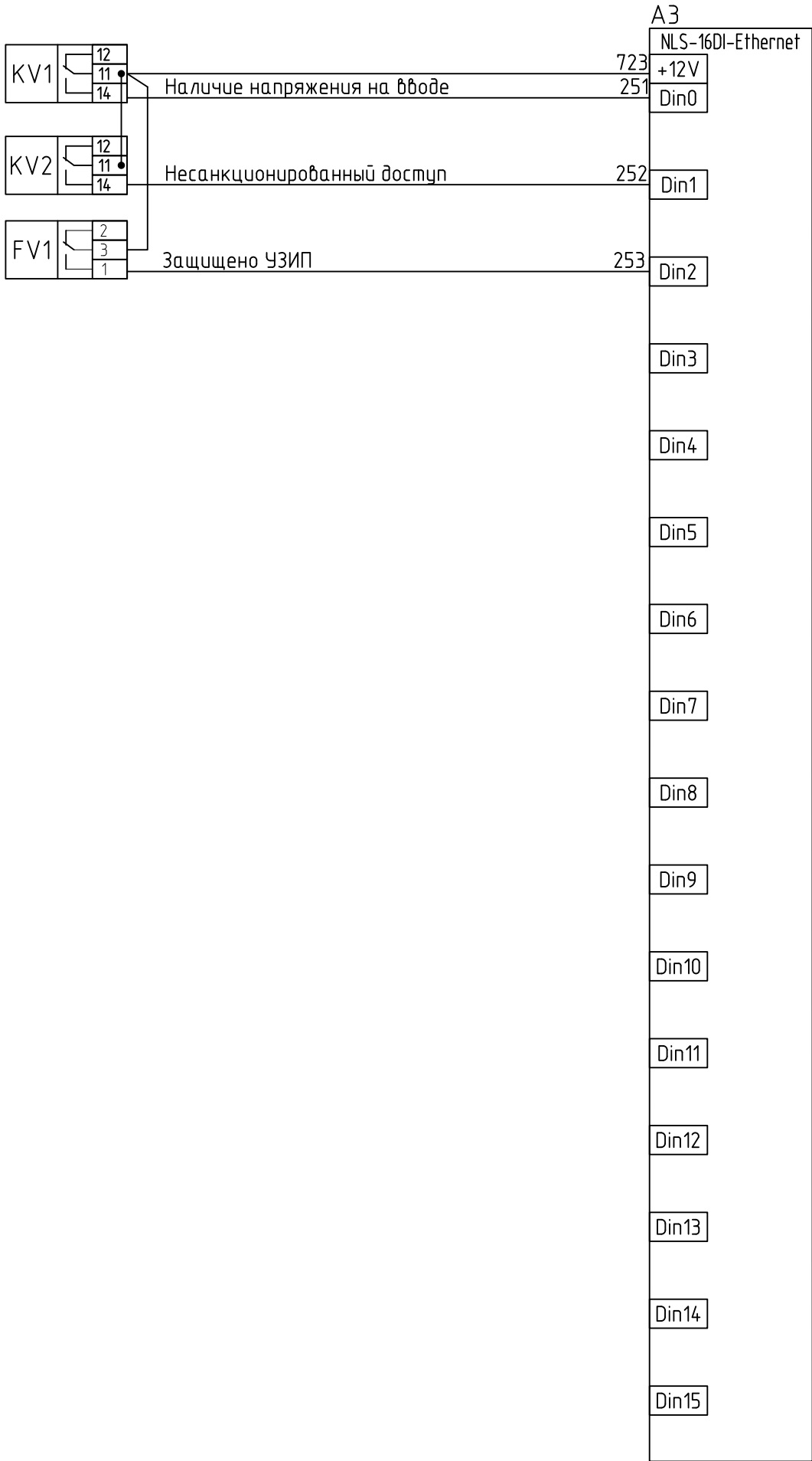
Схема подключения дискретных входных сигналов
