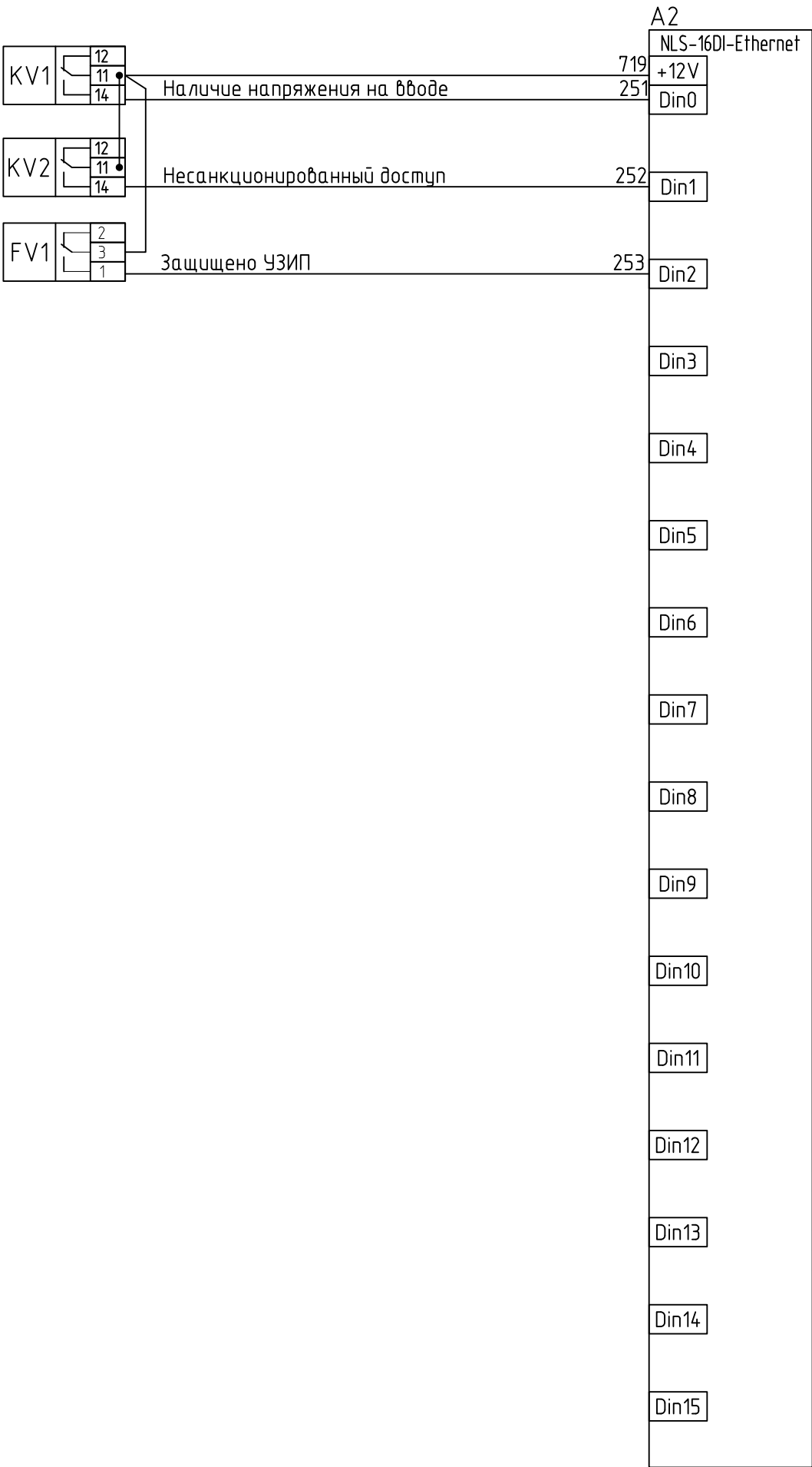
Схема подключения дискретных входных сигналов
