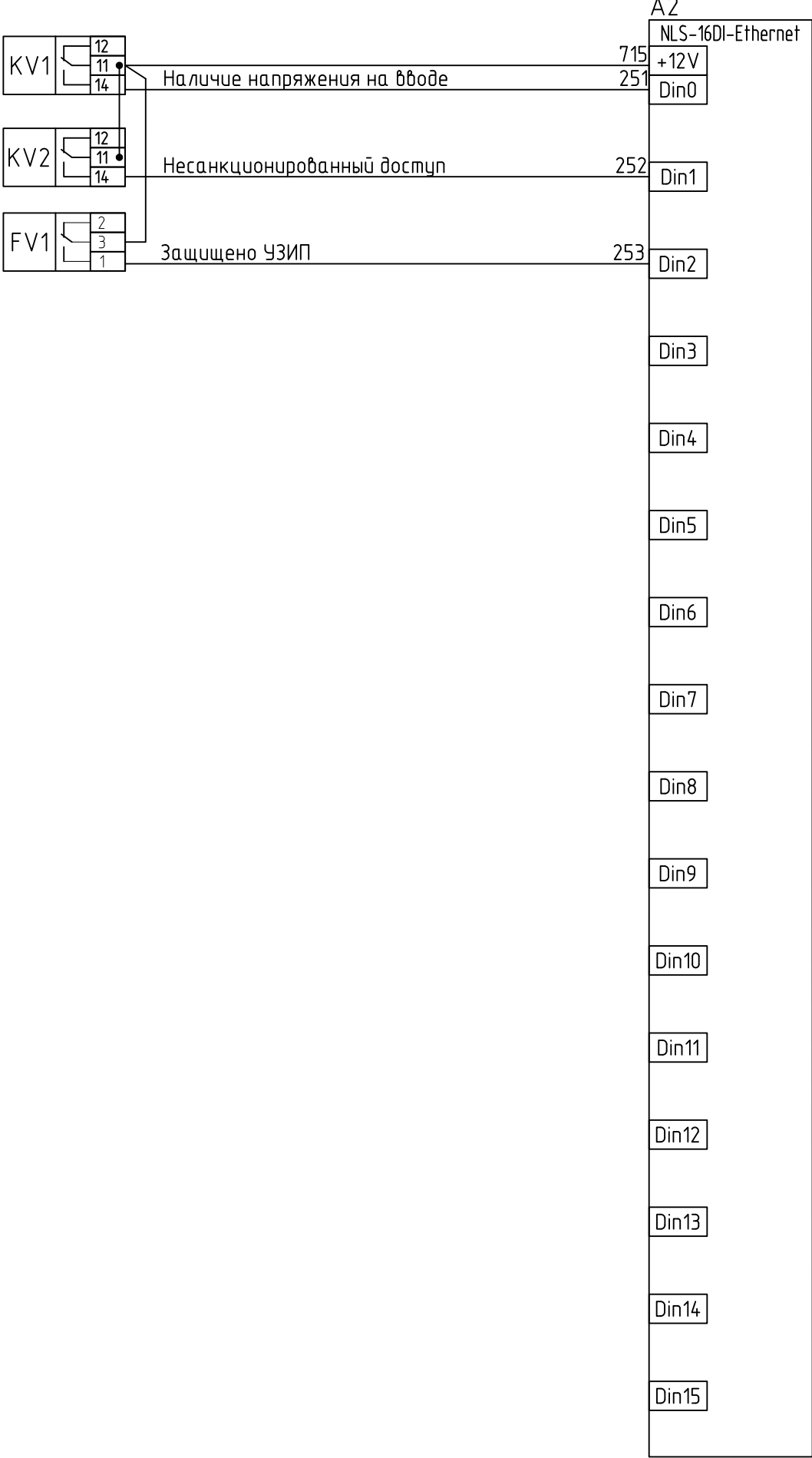
Схема подключения дискретных входных сигналов
