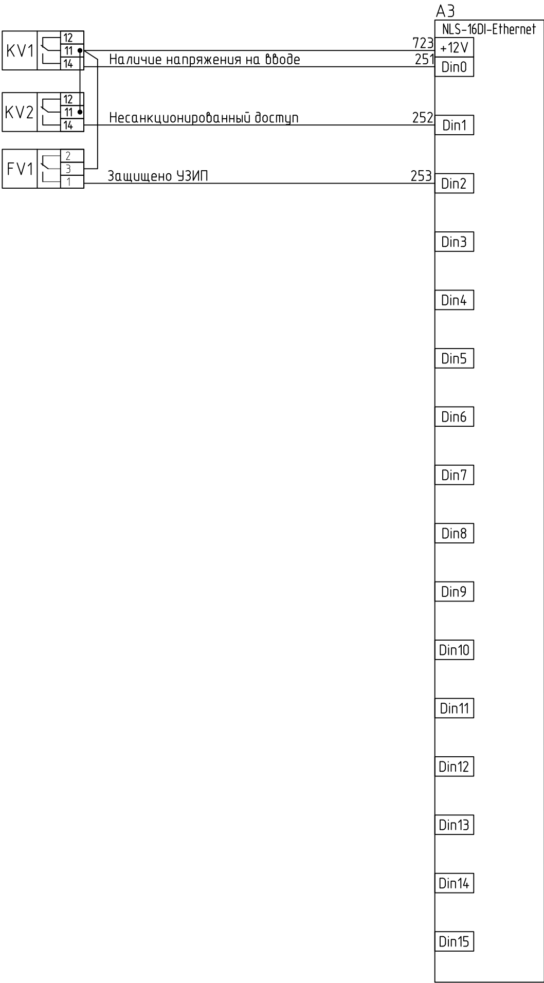
Схема подключения дискретных входных сигналов
